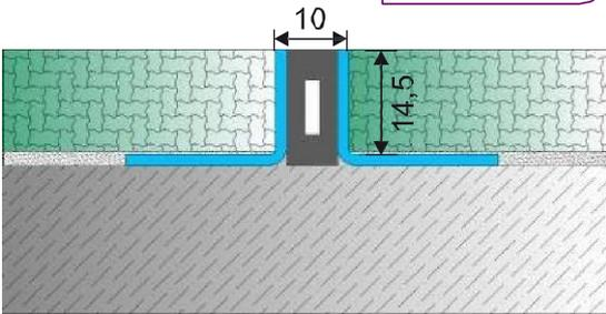
Aço inoxidável com perfis de junção de inserção de Neoprene. Garantia de cobertura de piso de 14mm.
