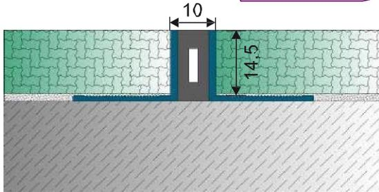
Alumínio com perfis de junção de inserto de neoprene. Ideal para cobertura de piso de 14mm.
