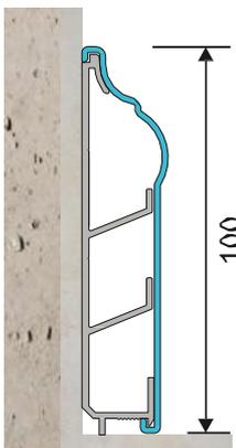
O PVC decorativo que contorna com canal de cabo completamente compatível com cerâmica, granito, o mármore etc...
