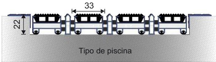
Trata-se de um sistema de tapete ao ar livre que impregna sujidade e lama por meio de suas tiras de borracha e raspadores de alumínio localizados nos perfis. O sistema de tapete duradouro constituído por esteiras unidas umas com as outras por cabos de aço, pode ser equipado com armação ou pode ser produzido como tipo de piscina inserido em um slot específico. Sua profundidade é de 2 cm. Fornece isolamento de som por meio de seus cabos de buffer mais baixos.
