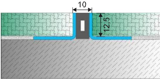
Aço inoxidável com perfis de junção de inserto de Neoprene. Ideal para cobertura de piso de 12mm.
