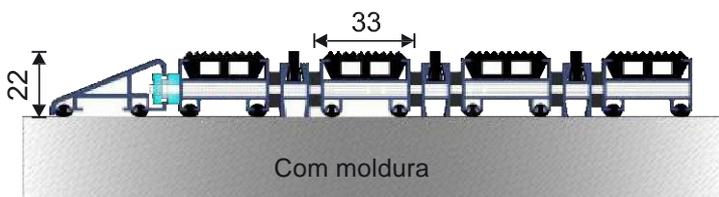
Trata-se de um sistema de tapete ao ar livre que impregna sujidade e lama por meio de suas tiras de borracha e raspadores de alumínio localizados nos perfis. O sistema de tapete duradouro constituído por esteiras unidas umas com as outras por cabos de aço, pode ser equipado com armação ou pode ser produzido como tipo de piscina inserido em um slot específico. Sua profundidade é de 2 cm. Fornece isolamento de som por meio de seus cabos de buffer mais baixos.
