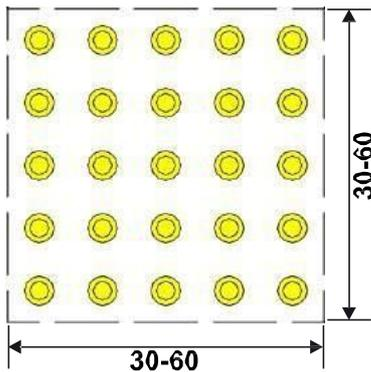
28 mm poliuretano parafuso escondido superfície tangível pontos de espera.
