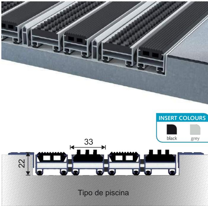
Trata-se de um sistema de tapete ao ar livre que impregna sujidade e lama por meio de suas tiras de borracha e raspadores de alumínio localizados nos perfis. O sistema de tapete duradouro constituído por esteiras unidas umas com as outras por cabos de aço, pode ser equipado com armação ou pode ser produzido como tipo de piscina inserido em um slot específico. Sua profundidade é de 2 cm. Fornece isolamento de som por meio de seus cabos de buffer mais baixos.
