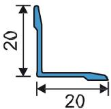
Perfis de canto interior cerâmico de alumínio de 20 \* 20 mm ...
