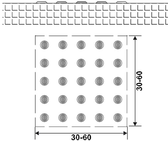
28 mm de aço inoxidável autoadesivo superfície tangível pontos de espera.
