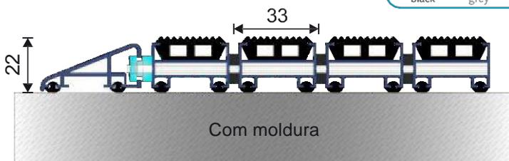
Trata-se de um sistema de tapete ao ar livre que elimina sujidade e lama por meio de suas tiras de borracha localizadas em perfis de alumínio. O sistema de tapete durável consistindo de esteiras unidas entre si, os cabos de aço podem ser equipados com armação ou podem ser produzidos como tipo de piscina inseridos em um slot específico. Sua profundidade é de 2 cm. Fornece isolamento de som por meio de seus cabos de buffer mais baixos.
