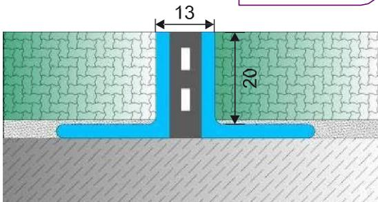
Aço inoxidável com perfis de junção de inserto de Neoprene. Ideal para cobertura de piso de 20mm.
