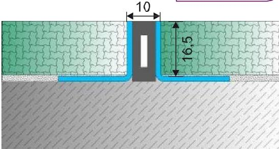
Aço inoxidável com perfis de junção de inserto de Neoprene. Ideal para cobertura de piso de 16mm.
