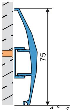
**ASP75** ... Pode ser aplicado em todos os tipos de revestimentos de pavimentos de 75 mm de altura, com cliques de montagem simples em alumínio ...
