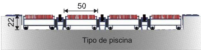
Trata-se de um sistema de tapete interno que elimina sujidade e lama por meio de seus perfis de alumínio com ampla superfície de tapete. O sistema de tapete durável consistindo de esteiras unidas entre si, os cabos de aço podem ser equipados com armação ou podem ser produzidos como tipo de piscina inseridos em um slot específico. Sua profundidade é de 2 cm. Fornece isolamento de som por meio de seus cabos de buffer mais baixos.
