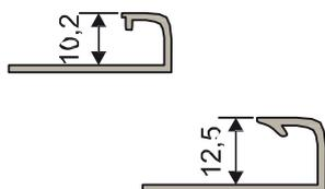
10 mm (SB 0106) & 12 mm (SB 0108) PVC cerâmico borda exterior perfil ...
