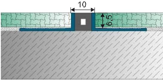
Alumínio com perfis de junção de inserto de neoprene. Ideal para cobertura de piso de 6mm.
