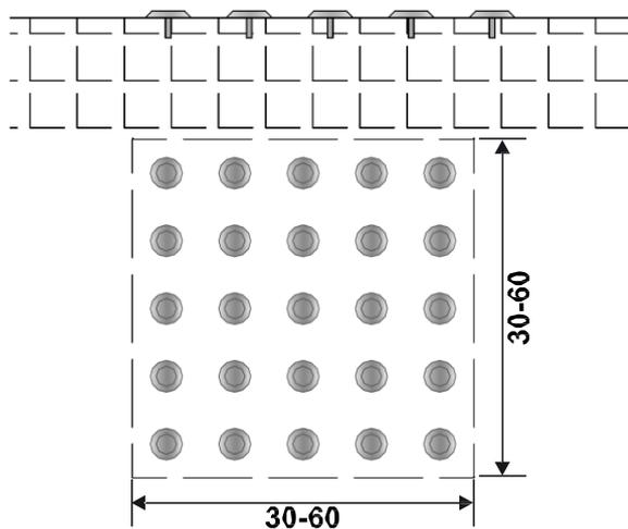
28 mm de aço inoxidável escondido parafuso superfície tangível espera pontos.
