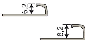
6 mm (SB 0106) & 8 mm (SB 0108) PVC cerâmico borda exterior perfil ...
