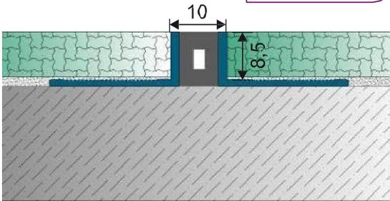
Alumínio com perfis de junção de inserto de neoprene. Ideal para cobertura de piso de 8mm.
