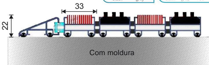
É um sistema de tapete interno que elimina sujidade e lama por meio de seus perfis de alumínio com superfície superior do tapete. O sistema de tapete durável consistindo de esteiras unidas entre si, os cabos de aço podem ser equipados com armação ou podem ser produzidos como tipo de piscina inseridos em um slot específico. Sua profundidade é de 2 cm. Fornece isolamento de som por meio de seus cabos de buffer mais baixos.
