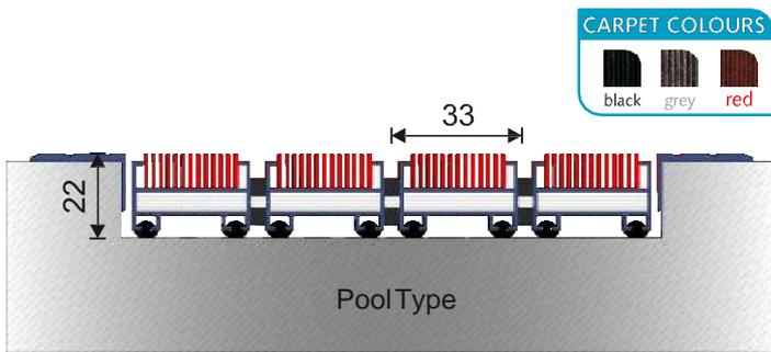
É um sistema de tapete interno que elimina sujidade e lama por meio de seus perfis de alumínio com superfície superior do tapete. O sistema de tapete durável consistindo de esteiras unidas entre si por os cabos de aço podem ser equipados com armação ou podem ser produzidos como tipo de piscina inseridos em um slot específico. Sua profundidade é de 2 cm. Fornece isolamento de som por meio de seus cabos de buffer mais baixos.
