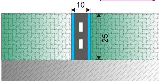
Aço inoxidável com perfis de junção de inserto de Neoprene. Ideal para cobertura de piso de 25mm.
