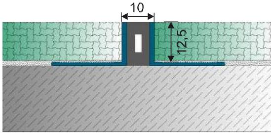
Alumínio com perfis de junção de inserto de neoprene. Ideal para cobertura de piso de 12mm.
