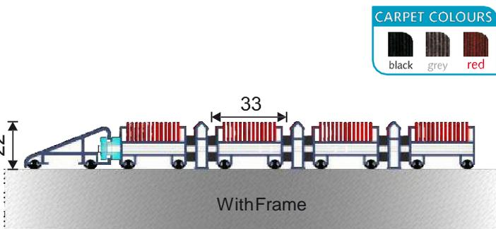
É um sistema de tapete interno que elimina sujidade e lama por meio de seus perfis de alumínio com superfície superior do tapete. O sistema de tapete durável consistindo de esteiras unidas entre si por os cabos de aço podem ser equipados com armação ou podem ser produzidos como tipo de piscina inseridos em um slot específico. Sua profundidade é de 2 cm. Fornece isolamento de som por meio de seus cabos de buffer mais baixos.
