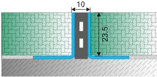
Aço inoxidável com perfis de junção de inserto de Neoprene. Ideal para cobertura de piso de 23mm.
