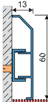
**ASP60** ... Pode ser aplicado em todos os tipos de revestimentos de pavimento de 60 mm de altura, com cliques de montagem simples em alumínio ...
