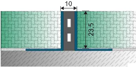
Alumínio com perfis de junção de inserto de neoprene. Ideal para cobertura de piso de 23mm.
