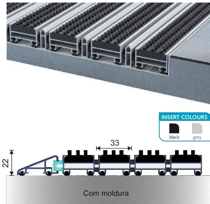
Trata-se de um sistema de tapete ao ar livre que impregna sujidade e lama por meio de suas tiras de borracha e raspadores de alumínio localizados nos perfis. O sistema de tapete duradouro constituído por esteiras unidas umas com as outras por cabos de aço, pode ser equipado com armação ou pode ser produzido como tipo de piscina inserido em um slot específico. Sua profundidade é de 2 cm. Fornece isolamento de som por meio de seus cabos de buffer mais baixos.
