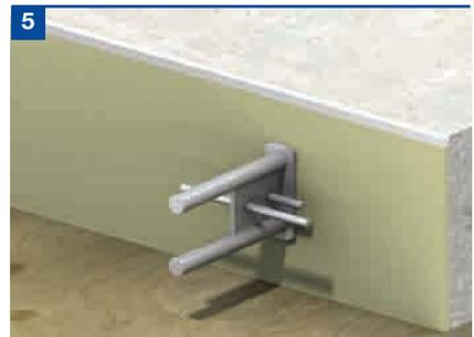
5 Empurrar o componente de cavilha através do material de preenchimento da junta (se aplicável), até que esteja completamente inserido no componente de manga. Pode ser necessário bater no componente cavilha para vencer as saliências de fixação existentes na manga que impedem a sua deslocação pela vibração do betão.
